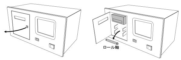
2.ロール軸を記録紙にセットし、記録紙の先端を下図のようにプリンタ機構ローラー下部へ差し込むとオートローディングされ、自動的にオートカットを行います。
