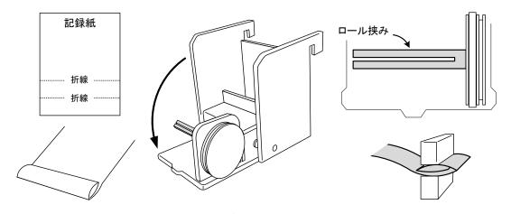
3. 本器にて巻取り動作を実行し、記録紙が空回りしない事を確認した後、巻取り器の前面パネルを閉じてセット終了です。
