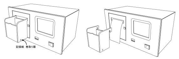
2.記録紙の先端を下図のように折り畳み、巻取り器前面パネルのロール挟み部に挟み込みます。
